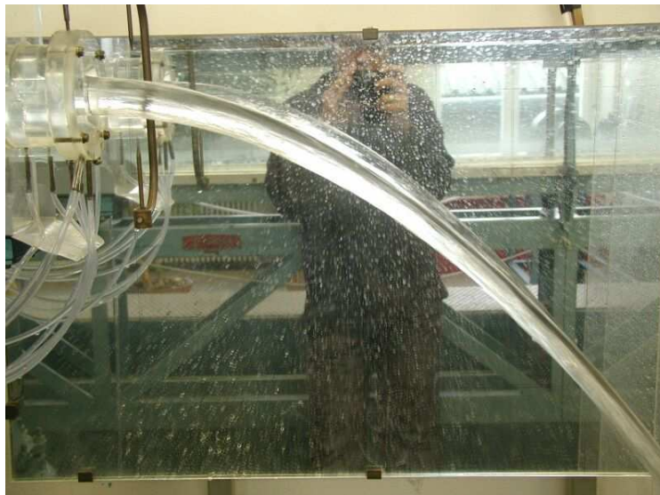
Freistrahлverlauf in Form einer Wurfparabel nach einer scharfkantigen Abschlussblende
